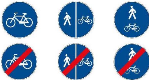
Fig 1a: Cartelli di inizio e fine di pista ciclabile. (figg II 90 e 91, art 122, DPR 495/92)
