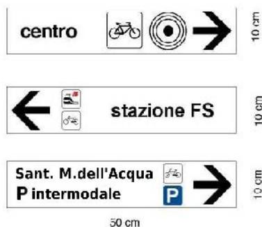
Fig 2: Segnali di direzione urbano (sottodimensionati per viabilità riservata) composto da fig. tab II 13/a e figure art. 125 DPR 495/92)
