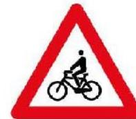
Fig 3: Cartello di pericolo per attraversamento ciclabile in strade extraurbane o urbane con velocità superiore a quello stabilito dall'art. 142 comma 1 del CdS. (fig II 14 art 88, DPR 495/92)
