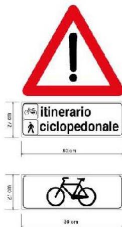
Fig 4: Possibile cartello di pericolo generico (fig. II, art 103 DPR 495/92, con pannello integrativo, (mod II 6 art 83 DPR 495/92) da porre su strada a viabilità ordinaria per segnalare la frequente e probabile presenza di ciclisti, ovvero dell'**itinerario ciclopedonale** (Eventualmente da utilizzarsi abbinato a limite di velocità 30 o meno vedi Tab 6c)
