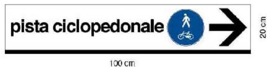
Fig 2a: Segnale "piccolo" di direzione urbano composto da fig. tab II 13/a e fig. II 92b art. 122 DPR 495/92)
