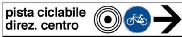
Fig 2b Segnale "piccolo" di direzione urbano composto da fig. tab II 13/a e fig. II 90 art. 122 e fig. II 100 art. 125 DPR 495/92)
