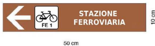
Fig 2: Segnale di direzione ottenuto dai segnali turistici per contesti urbani (riduzione da segnale tabella II 13a DPR 495/92)
