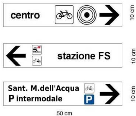
Fig 2: Segnali di direzione urbano (sottodimensionati per viabilit  riservata) composto da fig. tab Il 13/a e figure art. 125 DPR 495/92)
