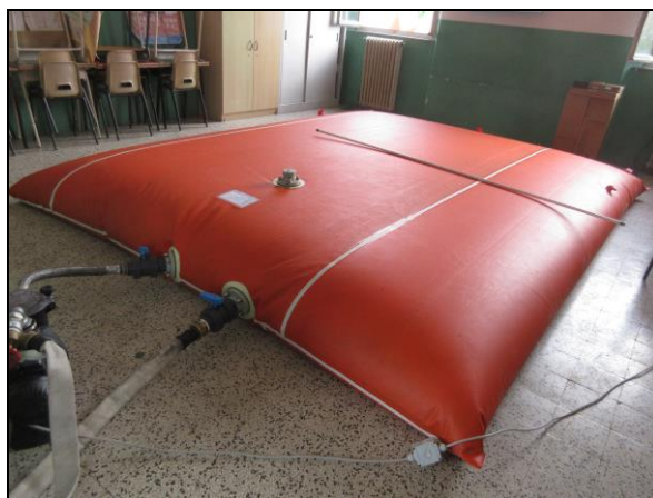
Foto n°2 - Posizionamento del serbatoio all'estradosso del solaio dell'Aula 5 al primo piano.
