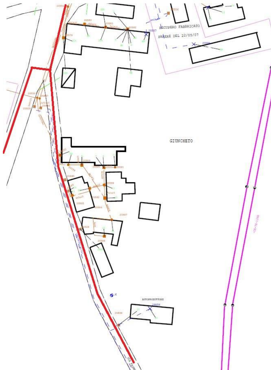
Figura 3 Interferenze con la rete elettrica in Via Palmerino
