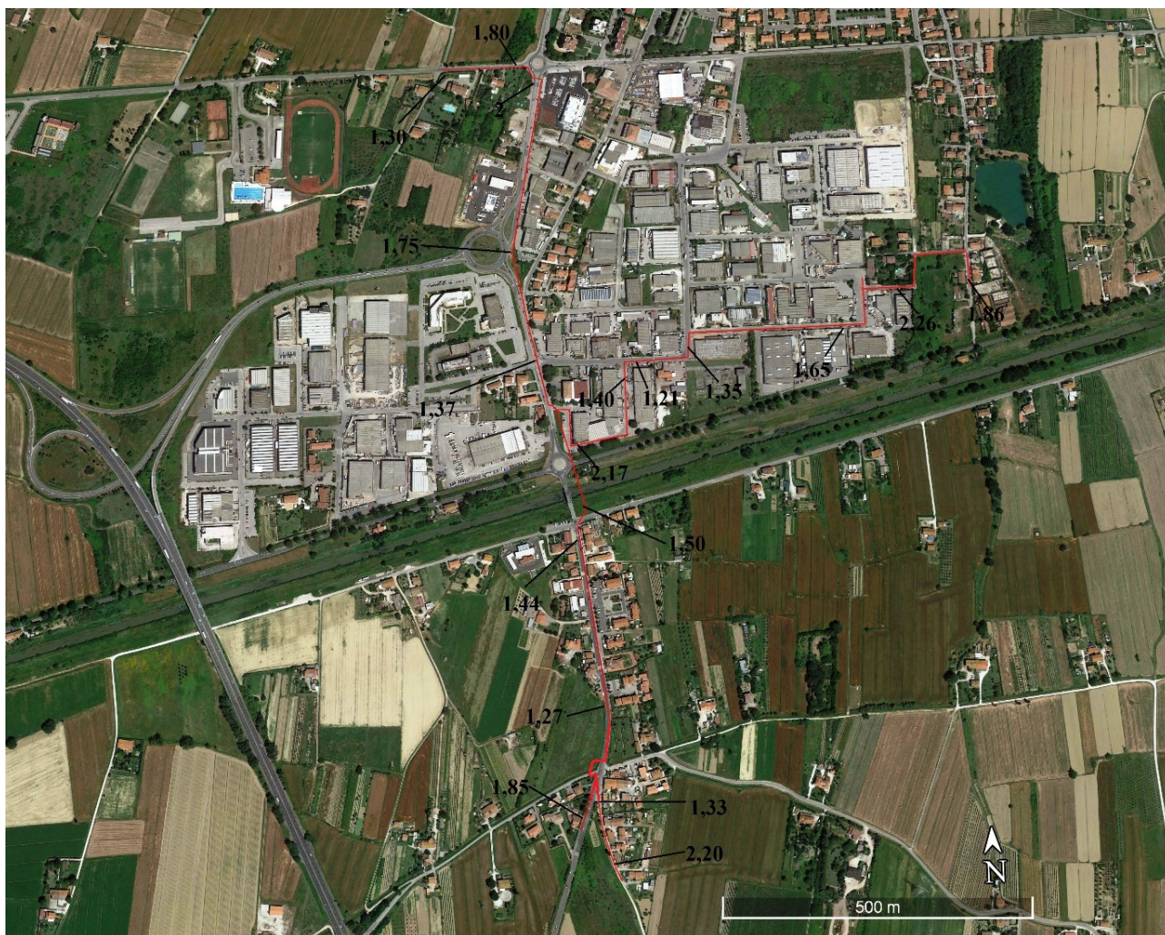
Planimetria dell'Intervento "A" Cascina con le quote indicative di scavo espresse in metri per ciascun settore.
